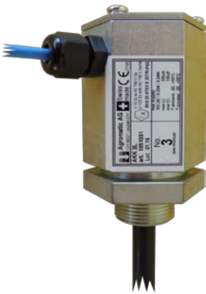
Gehängekopf AKK12 mit Normgewinde 3/4" G, 2 Kabelanschlüsse für serielle 2-Draht Verdrahtung mit digitalen Temperaturmessfühlern
